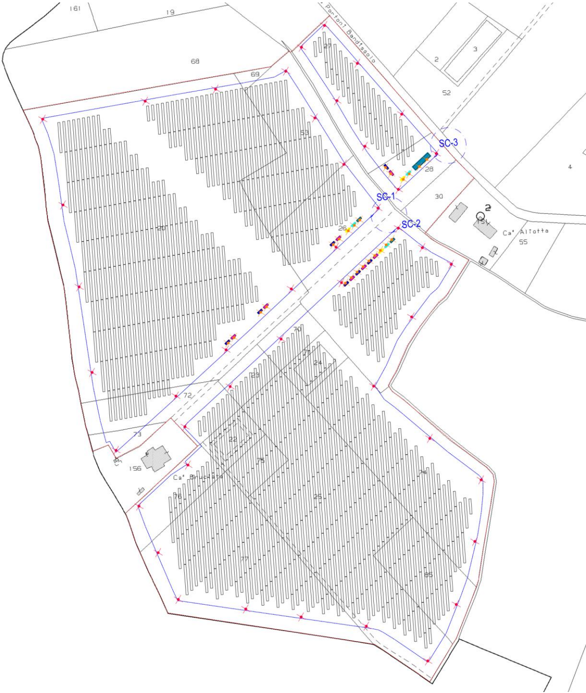
Figura 5.1: Layout preliminare di impianto con posizionamento dei corpi illuminanti
