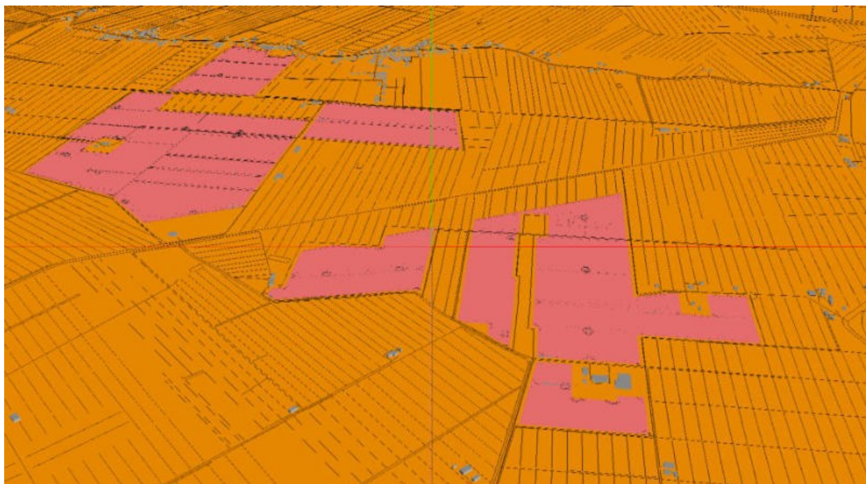
Figura 92: Mapa ambiente propagazione (modello previsionale) con indicazione area campo fotovoltaico e ricettori individuati
