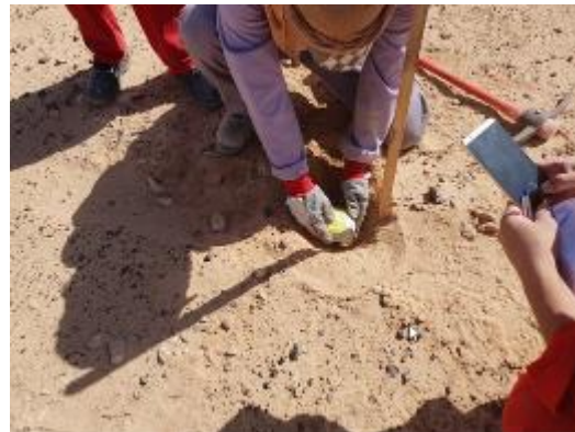
Fig. 12 - Punta da penetrare nel terreno e operazione di infissione.
