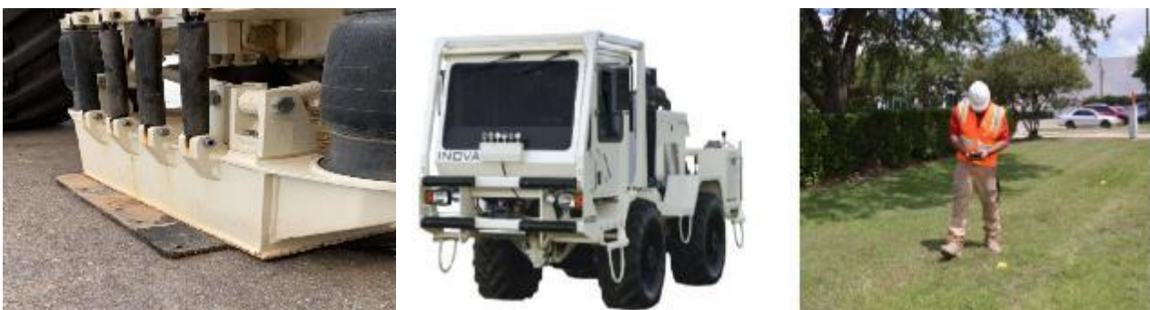
Fig. 9 – Esempio di piastra, di autocarro, e dell'allestimento della linea di rilevatori con sistema di geofoni wireless.
