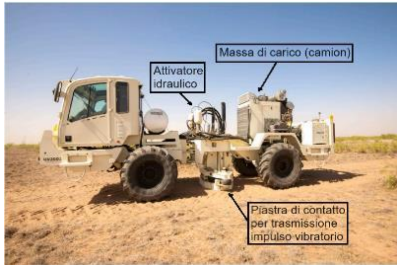
Fig. 7 – Esempio di autocarro con sistema Vibroseis.
