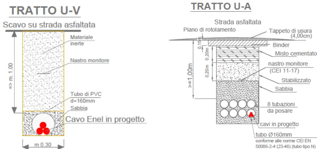
Figura 21: Sezione scavo in uscita dalla cabina di consegna fino al primo palo (interrata)
