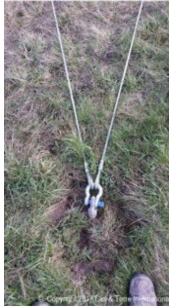
Figura 35: Esempi degli elementi di ancoraggio
