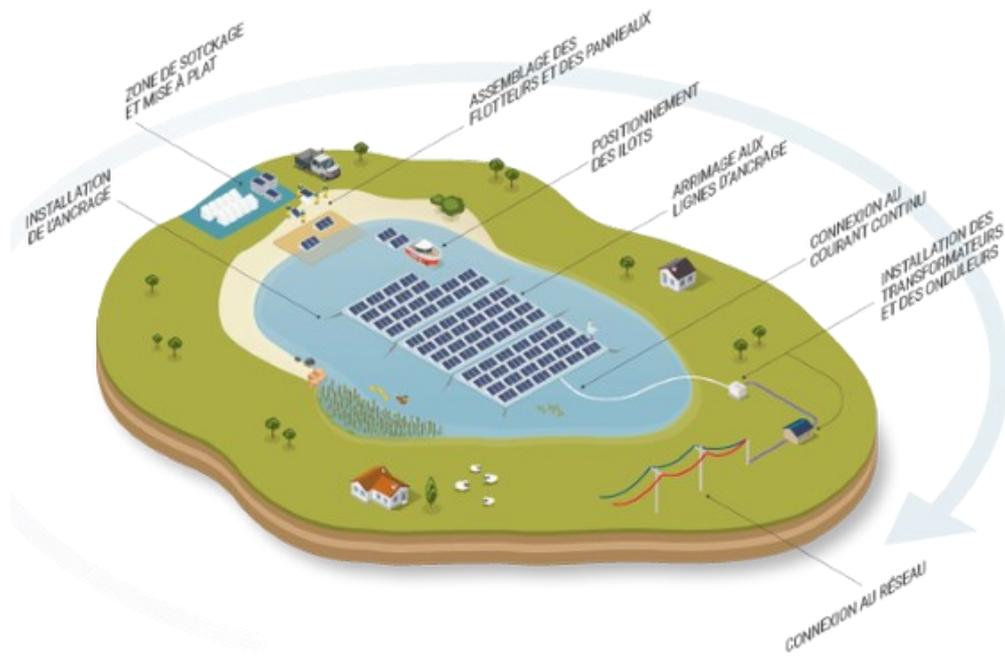
Figura 14: Elementi che caratterizzano queste tipologie di impianto flottanti e della sua installazione
