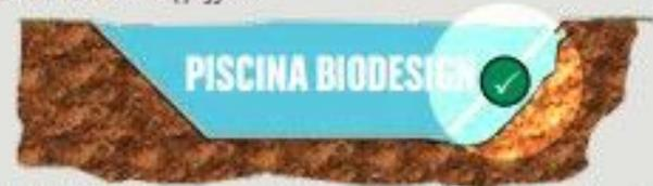
Una piscina Biodesign supporta un carico della struttura molto limitato (circa  $70\text{kg} \times \text{m}^2$ ) e NON subisce alcun carico dalla spinta dell'acqua contenuta all'interno. La spinta dell'acqua è infatti trasferita interamente al terreno che, grazie al liner impermeabilizzante elastico fino al + 300% è libero di assestarsi senza provocare danni alla piscina.
