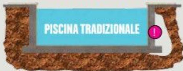
Una tradizionale piscina in cemento armato viene dimensionata per sopportare i carichi della struttura stessa (circa  $600\text{kg} \times \text{m}^2$ ) e della spinta dell'acqua contenuta all'interno ( $140\text{ cm}$  livello acqua =  $1400\text{ kg} \times \text{m}^2$ ). Il peso della struttura rigida unitamente al peso dell'acqua gravano complessivamente sul terreno su cui appoggiano.
