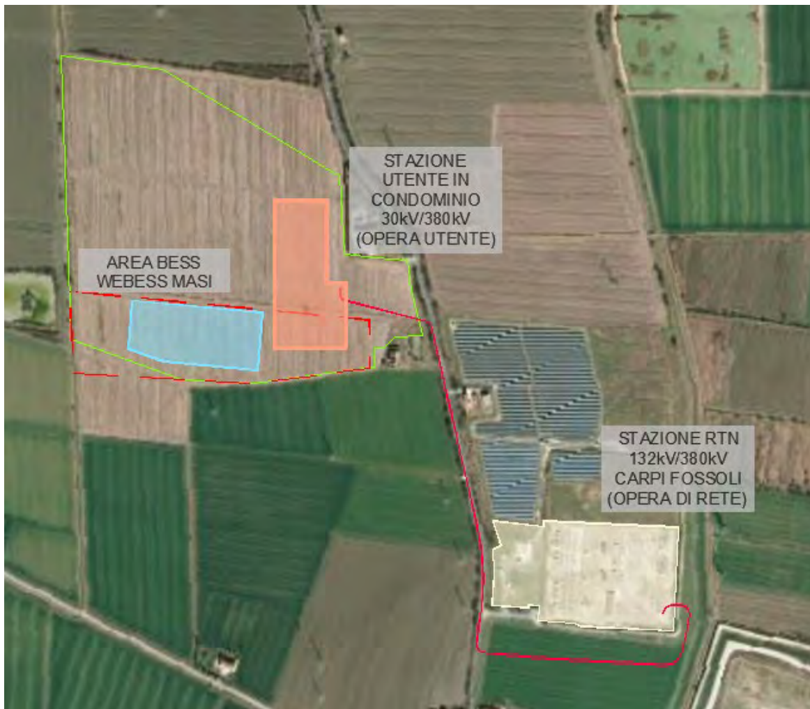
Figura 12. Collegamento con la Stazione Elettrica RTN di Carpi Fossoli
