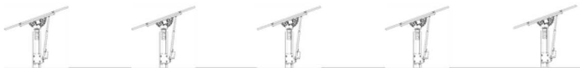
Fig.9: Le posizioni di sicurezza delle varie file all'interno del campo fotovoltaico.
