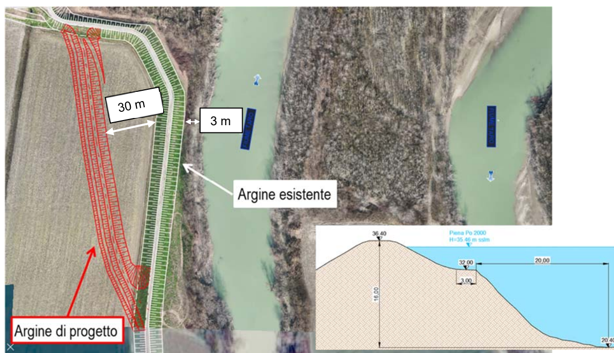
Figura 8.2: Estratto Tav.PFTE.10 – Planimetria arretramento argine maestro 2024
