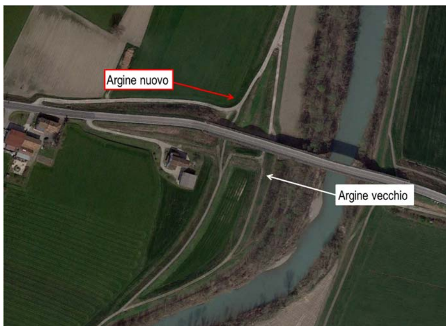
Figura 8.3: Estratto Tav.PFTE.10 – Planimetria smantellamento argine S. Secondo
