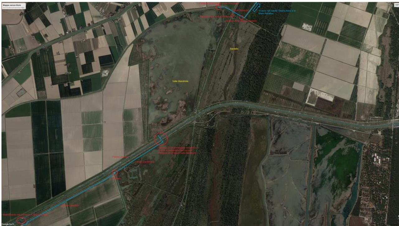
**Figura 4 – Sistema delle zone umide a nord del fiume Lamone: individuazione del percorso delle acque; localizzazione dei manufatti idraulici; denominazione delle zone umide (in blu il percorso delle acque; in rosso localizzazione, nome e funzione dei manufatti idraulici; in giallo denominazione delle zone umide).**
