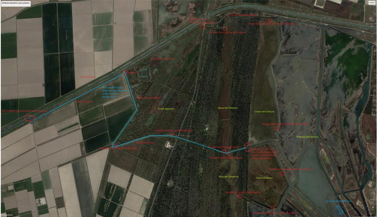
**Figura 3 – Sistema delle zone umide a sud del fiume Lamone: individuazione del percorso delle acque; localizzazione dei manufatti idraulici; denominazione delle zone umide (in blu il percorso delle acque; in rosso localizzazione, nome e funzione dei manufatti idraulici; in giallo denominazione delle zone umide).**
