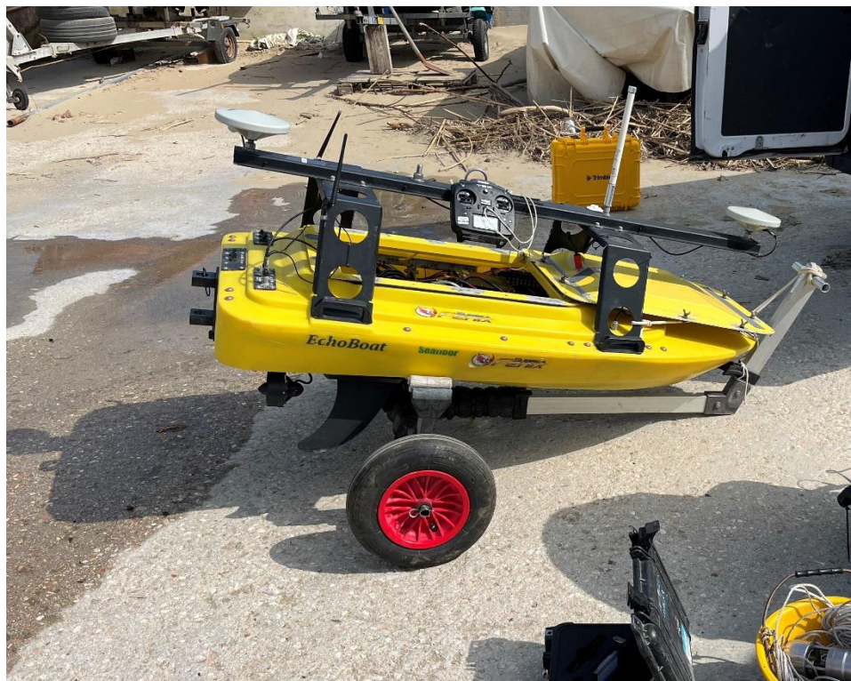
Figura 2– Particolare del drone utilizzato per il rilievo Multibeam
