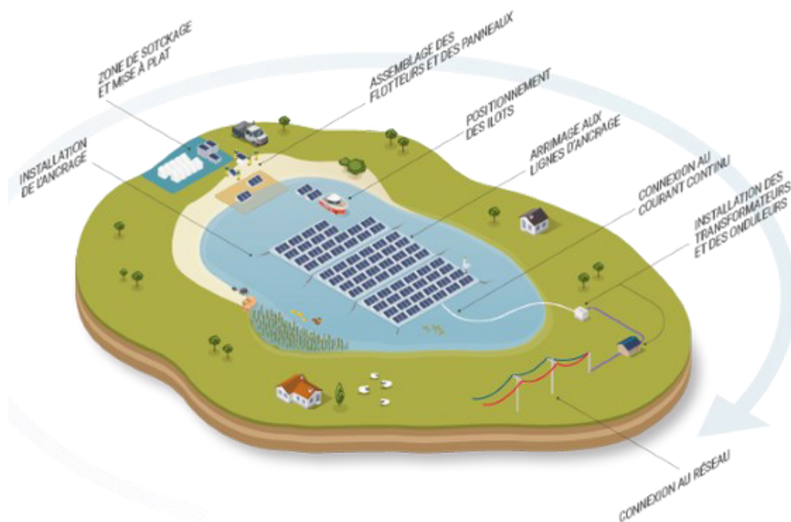
Figura 12: Elementi che caratterizzano queste tipologie di impianto flottanti e della sua installazione
