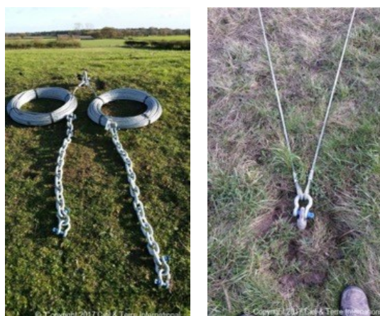
Figura 20: Esempi degli elementi di ancoraggio
