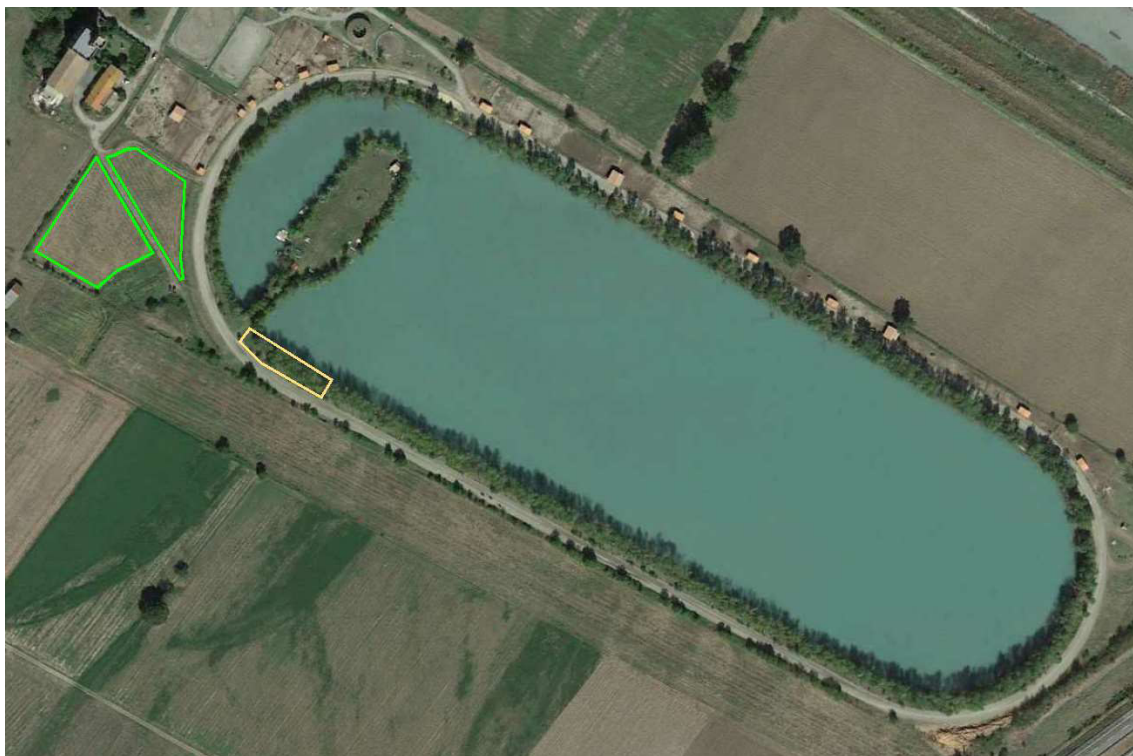
Figura 6: Localizzazione aree di cantiere; in verde l'area con locale ad uso ufficio, parcheggio e stoccaggio materiali, in giallo l'area di assemblaggio e varo dell'impianto
