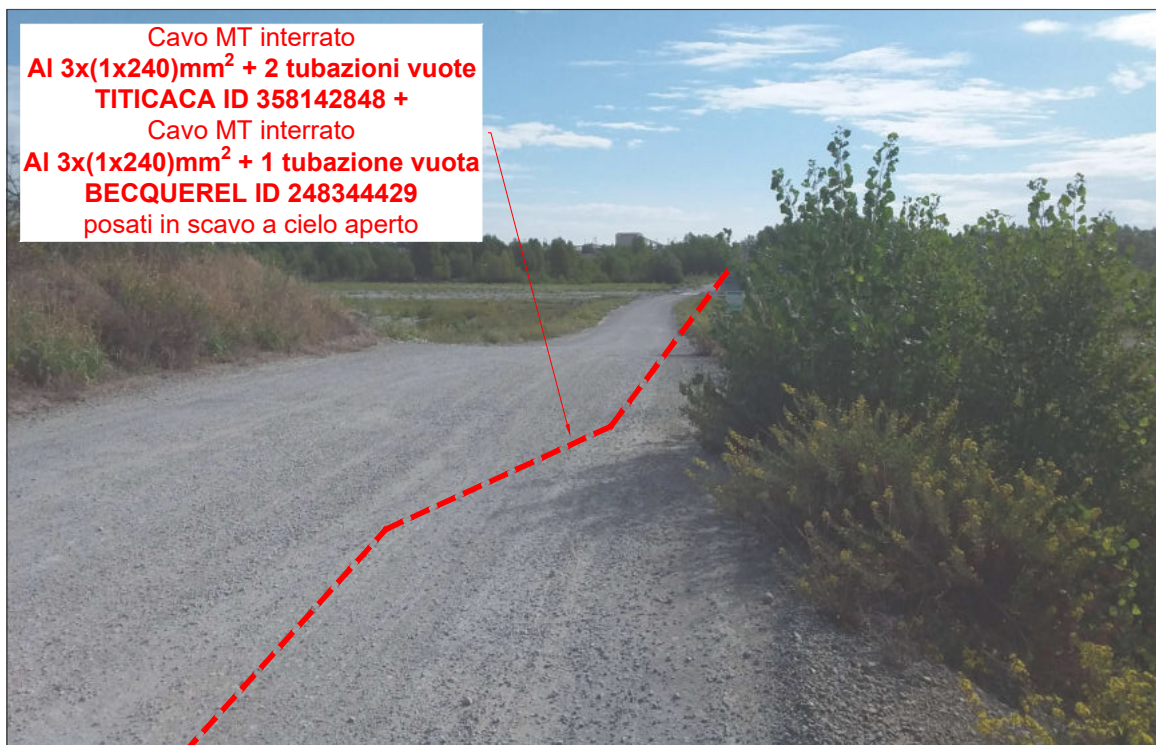
Foto 22: Nuova linea MT in partenza dalla cabina primaria CP COLLECCHIO in arrivo tramite lancio TOC per attraversamento Fiume Taro in via Ghiaie Superiori, Comune di Medesano
