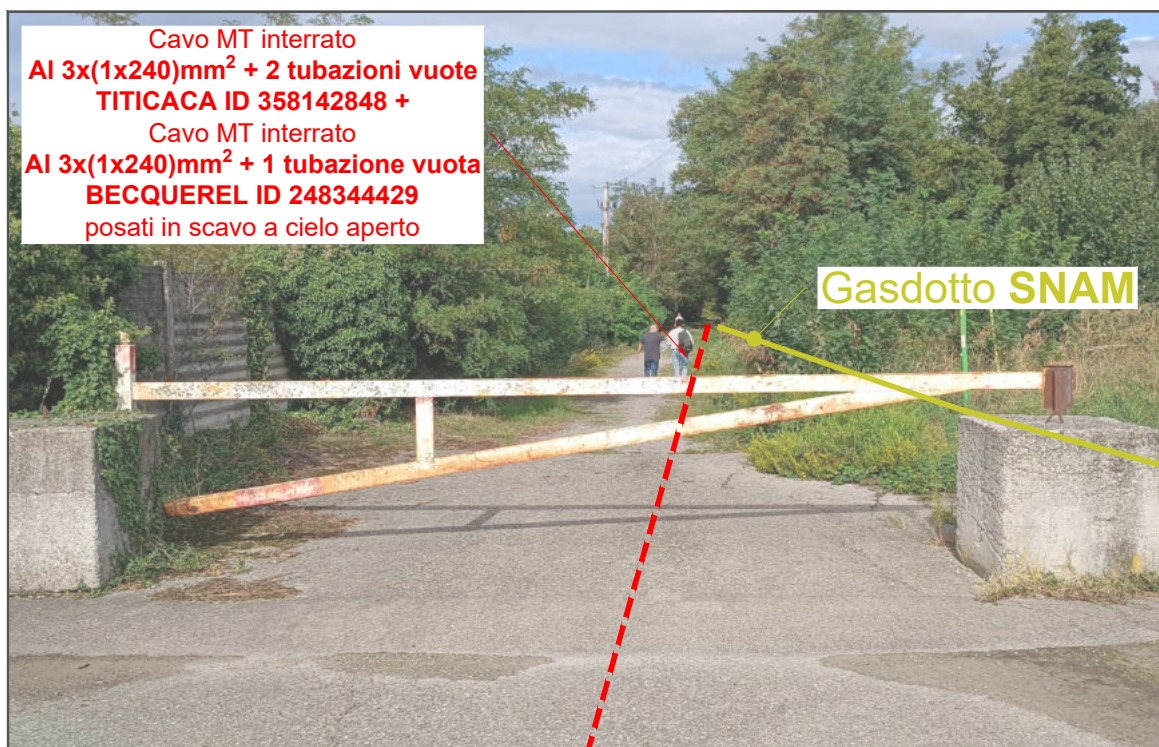
Foto 16: Nuova linea MT in partenza dalla cabina primaria CP COLLECCHIO in percorrenza lungo via Scodoncello ed in parallelismo a Gasodotto SNAM
