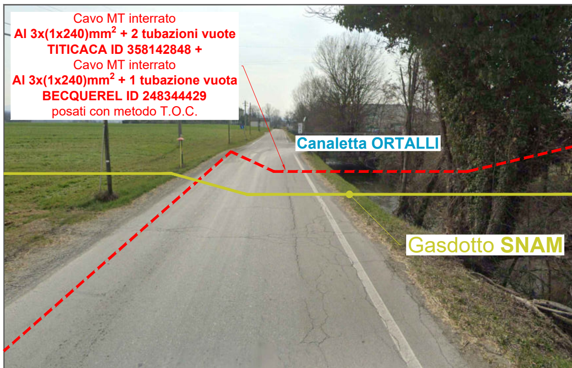
Foto 3: Nuova linea MT in partenza dalla cabina primaria CP COLLECCHIO in percorrenza lungo via Scodoncello e in attraversamento con Gasdotto SNAM
