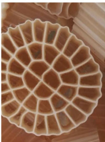
Figura 3-5: tipologia riempimento utilizzato per sistema IFAS
