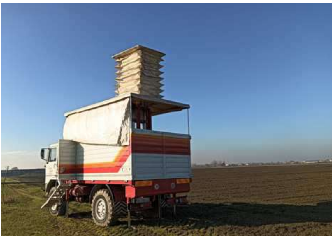
Fig.14. : Penetrometro statico su un punto di prova CPT eseguita nel Novembre 2023
