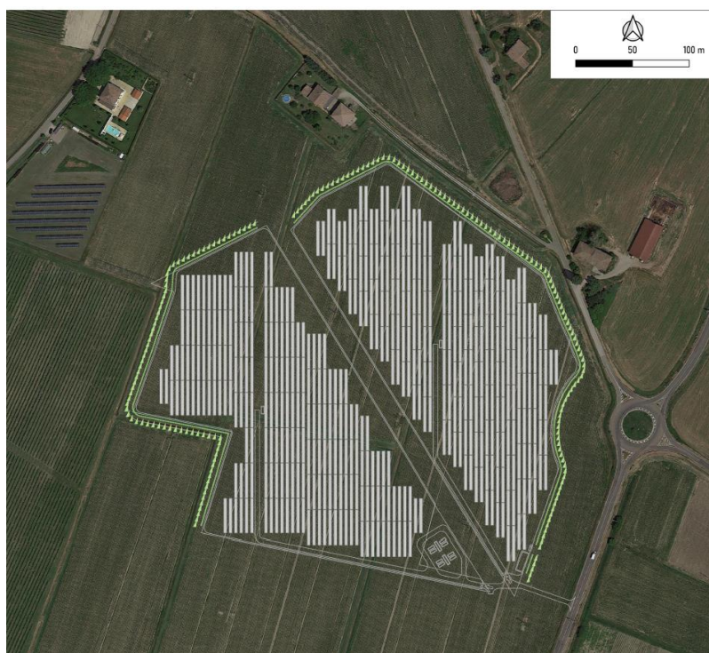
Figura 6- Intervento di mitigazione a doppio filare (cfr. 23XEL01_PD_N_TAV26.00- Mitigazione)
