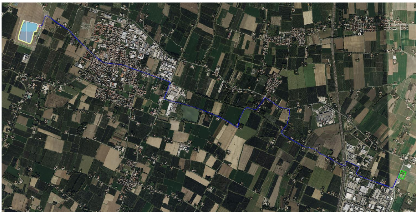
Figura 3- Inquadramento impianto FV sud con relativa connessione alla Cabina Primaria "Carpi Nord"
