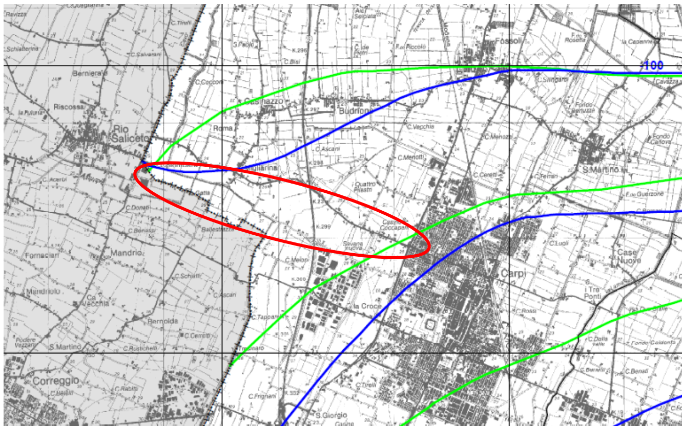
Figura 18- Stralcio della Carta dei depositi del sottosuolo che influenzano il moto sismico in superficie (P.T.C.P. Modena) – nel cerchio rosso l'area indicativa attraversata dalla connessione
