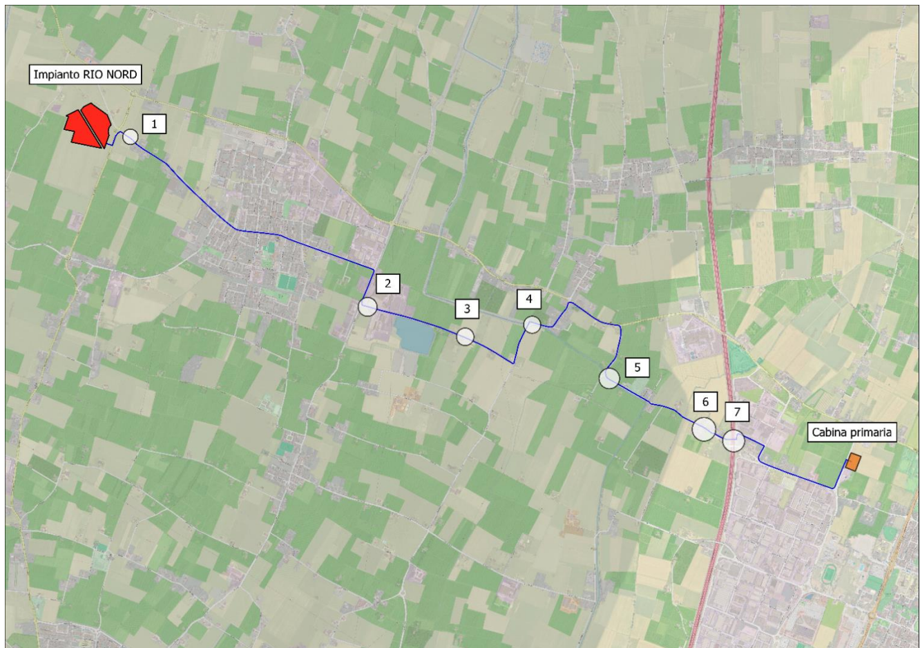
Figura 46 localizzazione dei punti di interferenza del cavidotto di connessione MT.
