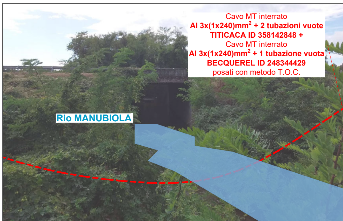
Foto 5: Nuova linea MT in partenza dalla cabina primaria CP COLLECCHIO in transito lungo la pista ciclabile parallela alla SS 62, in attraversamento dell'acqua pubblica Rio Manubiola.
