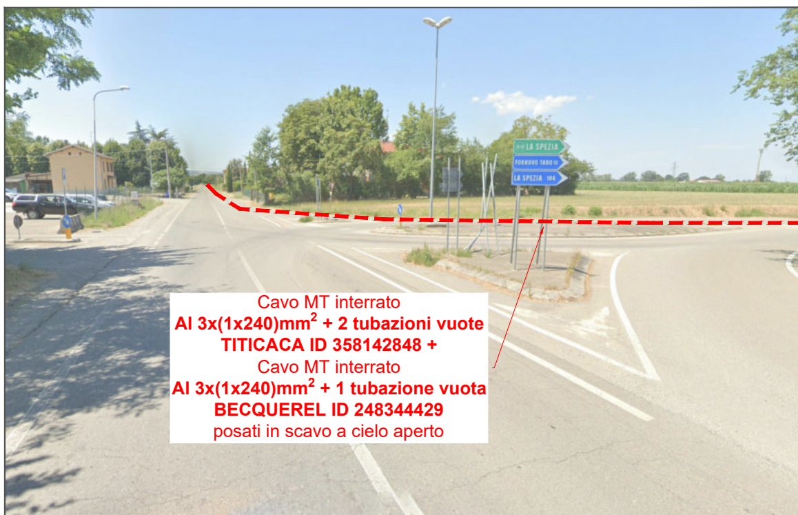
Foto 10: Nuova linea MT in partenza dalla cabina primaria CP COLLECCHIO in interferenza con lo svincolo della Strada Statale 62
