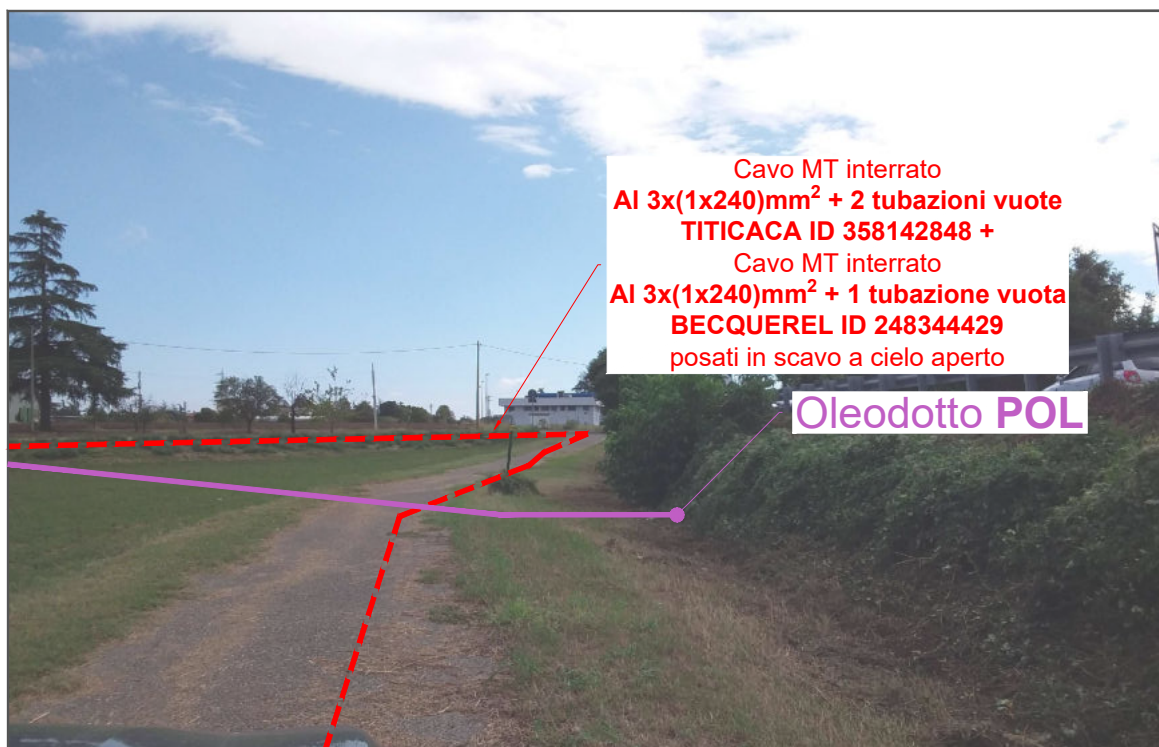
Foto 4: Nuova linea MT in partenza dalla cabina primaria CP COLLECCHIO in transito lungo la pista ciclabile parallela alla SS 62, in interferenza con Oleodotto POL.
