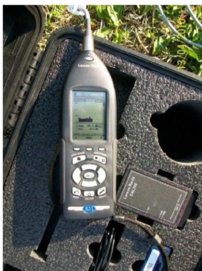
Figura 4 – Fonometro integratore/analizzatore Real Time LARSON DAVIS modello 831
